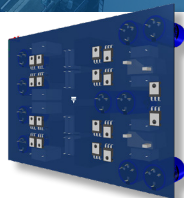
图 3: 22kW 车载充电器的主直流/直流转换器电路 (来源: Vishay)
