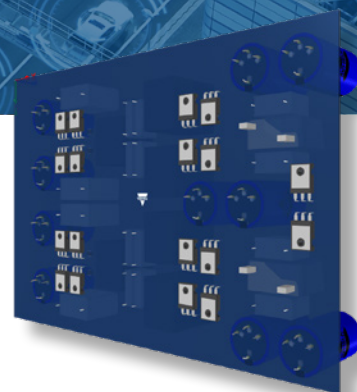
図 3: 22kW OBC主要DC/DCコンバータステージ (出典: ビシェイ)
