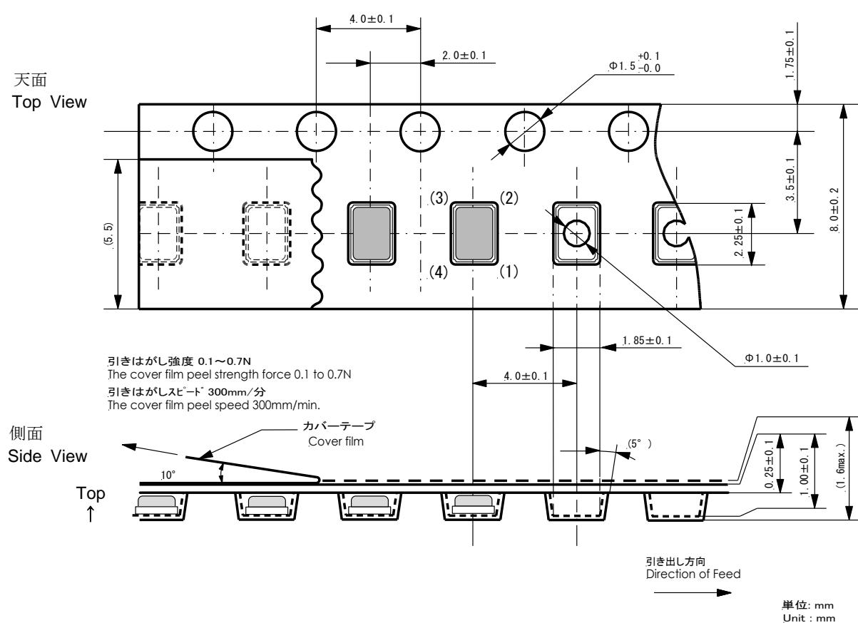
第2図 プラスチックテープの外形寸法図
