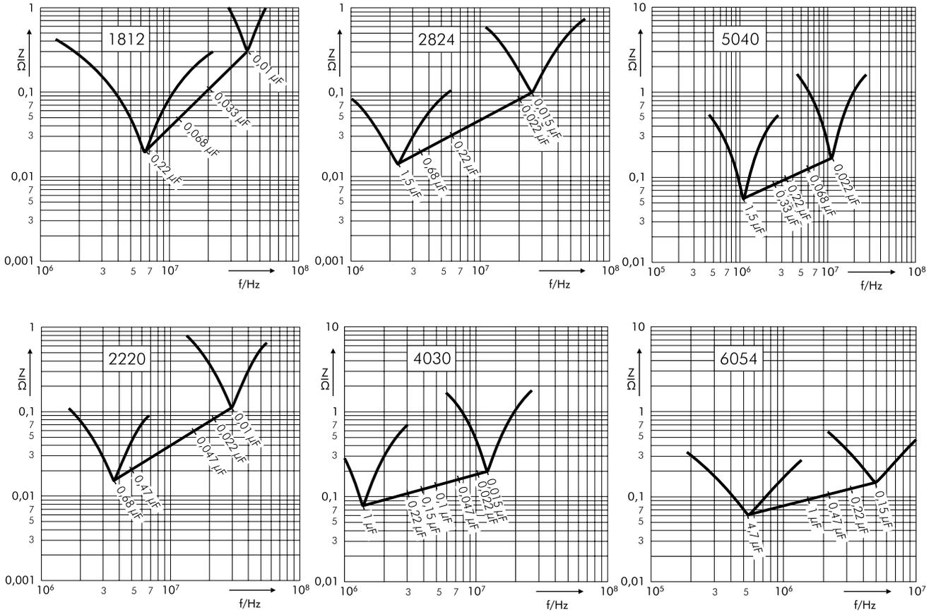
Zulässige Wechselspannung in Abhängigkeit von der Frequenz bei 10° C Eigenerwärmung (Richtwerte).
