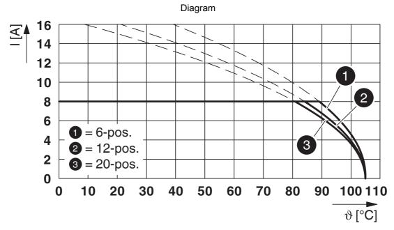
Type: DD31PC 2,2/...-3,81-Y with DD31H 2,2/...-V-3,81-Y
