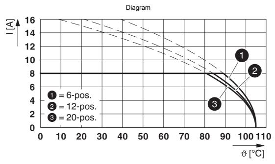
Type: DD31PC 2,2/...-3,81-Y with DD31H 2,2/...-H-3,81-Y
