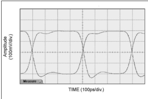
**FIGURE 2-7:** 1.25 GHz Output.
