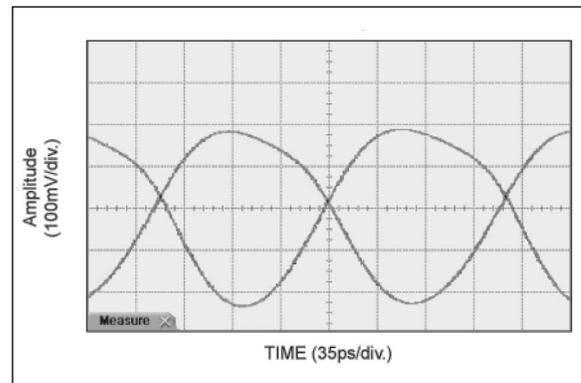
**FIGURE 2-5:** 4 GHz Output.
