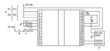
a : Contactorsb : Restartc : Feedbackd : Emergency stope : Light curtain
