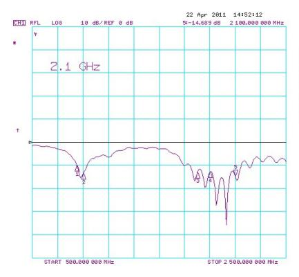
1:-10.138 dB 850.000 MHz 2:-13.658 dB 900.000 MHz 3:-13.208 dB 1.80000 GHz 4:-13.012 dB 1.90000 GHz
