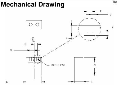
**Tolerance (mm)** +/- or max Dim Nominal (mm) 7.899 Max Α 9.271 Max в 4.496 Max С D 1.778 0.127 Ε 1.778 0.127 F 1.27 0.127 G 0.762 0.127 1.778 0.127 I J 0.762 0.127
