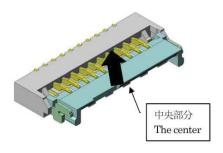
②FPC/FFC の導体面を下にして挿入して下さい。
