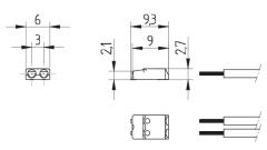
Generelle Empfehlung: Die beiden Lötflächen eines Klemmpoles auf der Platine sollten elektrisch miteinander verbunden werden.
