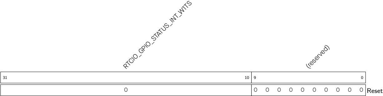
Register 5.59: RTCIO_RTC_GPIO_STATUS_W1TS_REG (0x001C)
