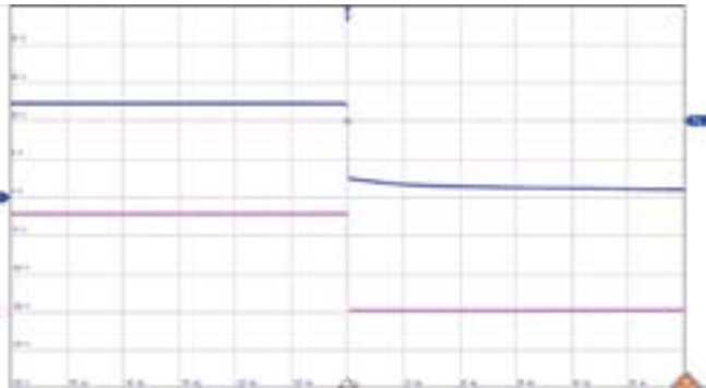
Ch1: Input voltage (5 V/div.) Time scale: (10 ms/div.) Ch2: Output voltage (5 V/div.)
