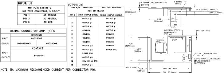
NOTE: 5A MAXIMUM RECOMMENDED CURRENT PER CONNECTOR PIN.
