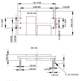
UNIT: mm[inch] BOTTOM VIEW: pin on upside L=4.60mm TOLERANCE: X.Xmm±0.5mm[X.XX in.±0.02in.] X.XXmm±0.25mm[X.XXX in.±0.01in.]
