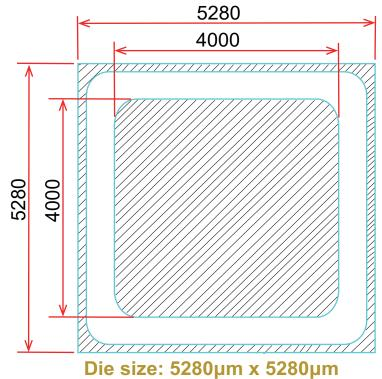
Bond pad size: 4000µm x 4000µm
