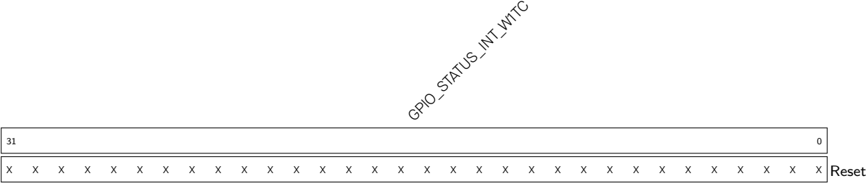
Register 4.18. GPIO_STATUS_W1TC_REG (0x004c)
