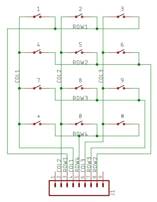
CONNECTOR PINOUT SHOWN FROM TOP (KEYCAP) SIDE OF BOARD
