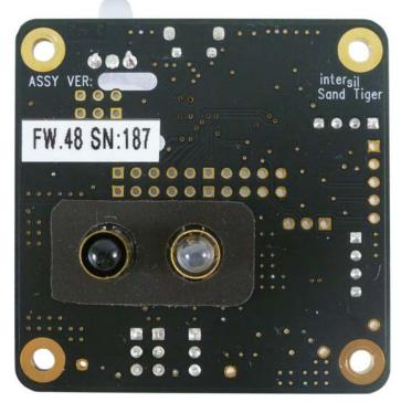
FIGURE 5. SAND TIGER BOARD BOTTOM SIDE
