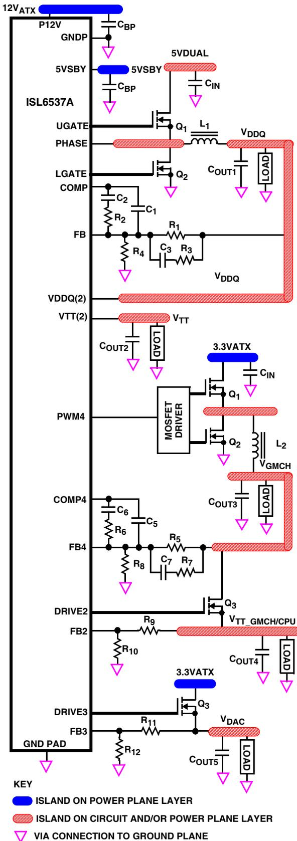
FIGURE 2. PRINTED CIRCUIT BOARD POWER PLANES AND ISLANDS
