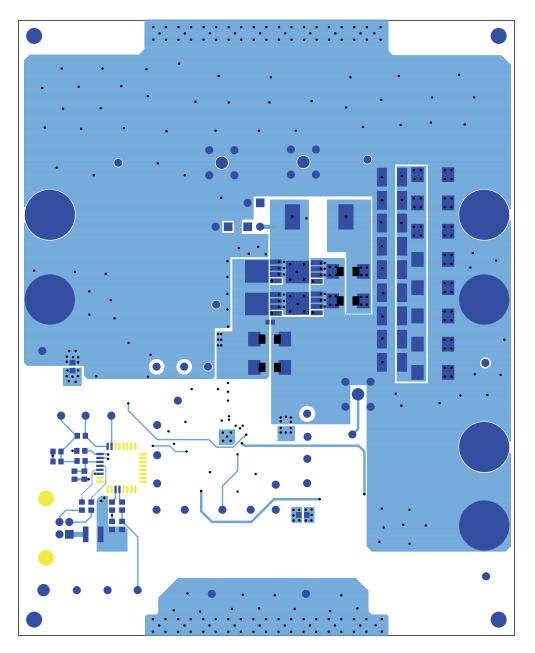
FIGURE 12. BOTTOM LAYER COPPER
