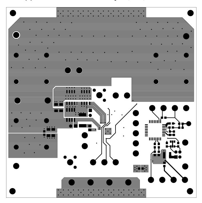
FIGURE 16. BOTTOM COPPER (BOTTOM VIEW)
