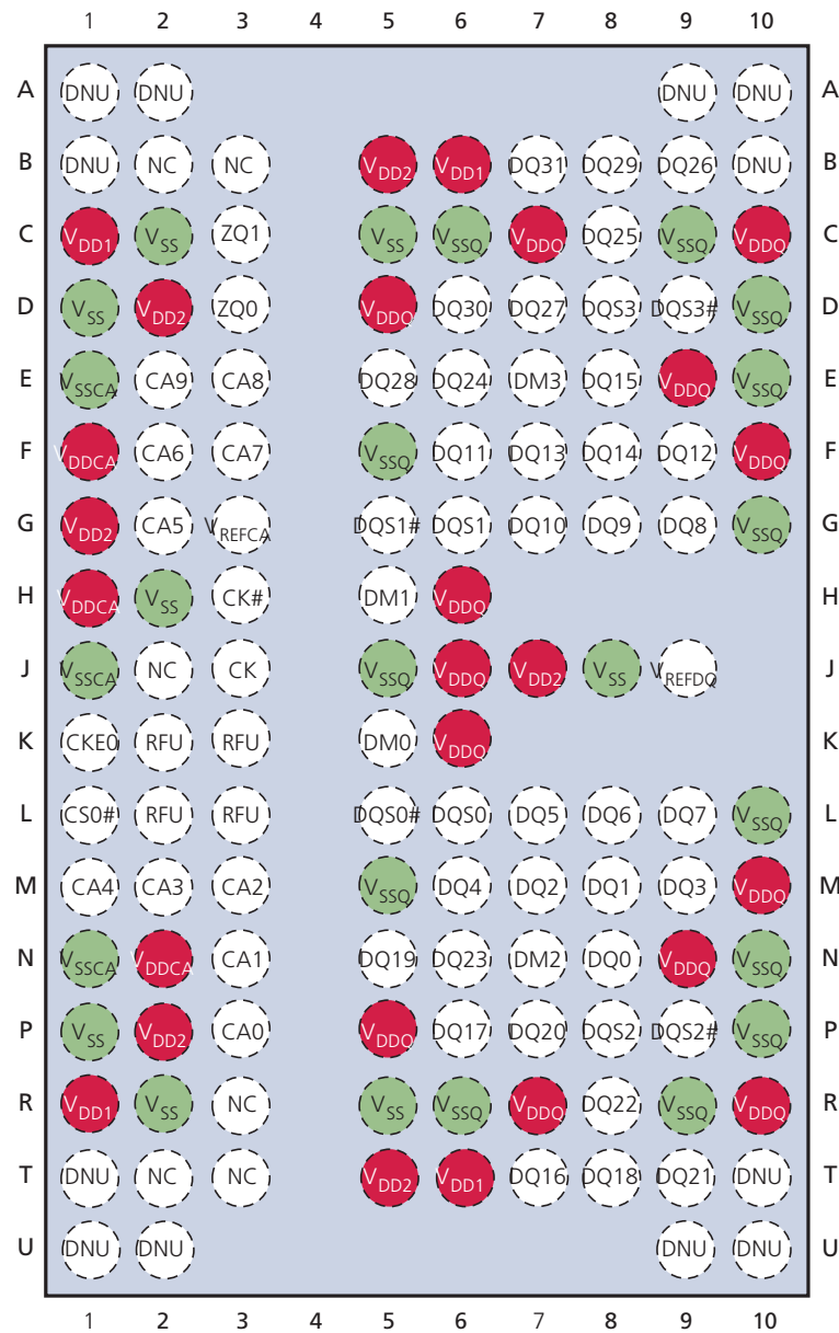
Figure 8: 134-Ball FBGA (32 Meg x 32, 64 Meg x 32)
