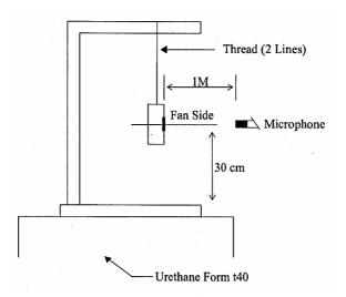
1 METER FROM MICROPHONE TO FAN INTAKE
