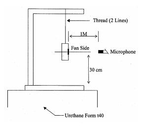
1 METER FROM MICROPHONE TO FAN INTAKE
