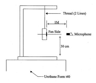
1 METER FROM MICROPHONE TO FAN INTAKE
