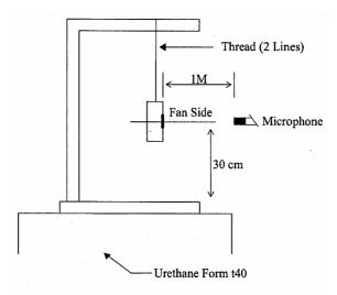
1 METER FROM MICROPHONE TO FAN INTAKE
