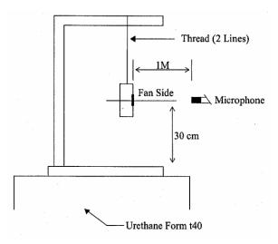
1 METER FROM MICROPHONE TO FAN INTAKE
