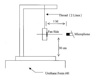
1 METER FROM MICROPHONE TO FAN INTAKE
