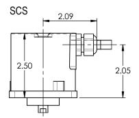
ALLOW FOR APPROX. 2 IN. CABLE BEND RADIUS BEYOND END OF CABLE GLAND
