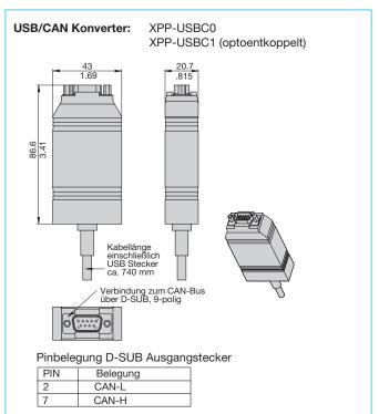
Es handelt sich um ein metrisches Design und Maßangaben in Millimeter haben Vorrang. Für Nennmaße ohne direkte Toleranzangabe gilt  $\pm$  IT13 nach DIN ISO 286. Bitte beachten Sie das Katalogdatenblatt zu Einbau- und Sicherheitshinweisen.
