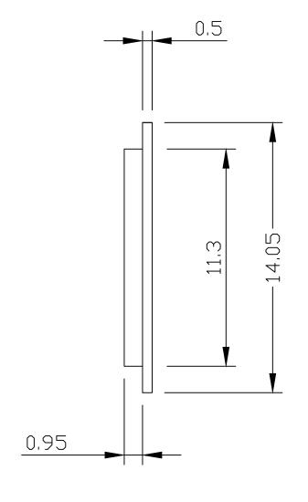
TOLERANCE ON HEIGHT OF PAD SHALL BE ±0.38MM
