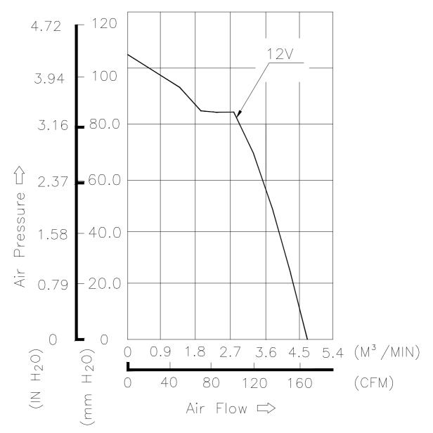
\* TEST CONDITION: INPUT VOLTAGE ------ OPERATION VOLTAGE TEMPERATURE ----- ROOM TEMPERATURE HUMIDITY ----- 65%RH
