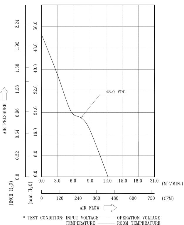
\* TEST CONDITION: INPUT VOLTAGE — OPERATION VOLTAGE TEMPERATURE — ROOM TEMPERATURE HUMIDITY — 65%RH
