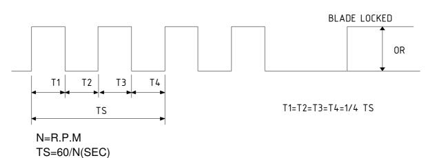
\*VOLTAGE LEVEL AFTER BLADE LOCKED
