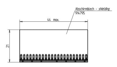
EE-Zone für durchkontaktierte Löcher Ø 0.6 ± 0.05 Compliant zone for thru hole Ø 0.6 ± 0.05 3<sub>-0.4</sub> 11.4
