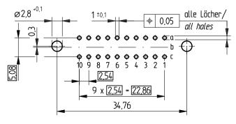
Tauchlötaschluß 0,65 x 0,3 mm / solder terminal 0,65 x 0,3 mm Isolierwerkstoff / hausing material : PBT GF30 Bauart 7 / type 7 Anforderungsstufe 2 = 400 Steckzyklen / performance class 2 = 400 mating cycles Fehlende Maße und Angaben nach IEC 60 603-2 / DIN EN 60 603-2 Missing information and dimensions per IEC 60 603-2
