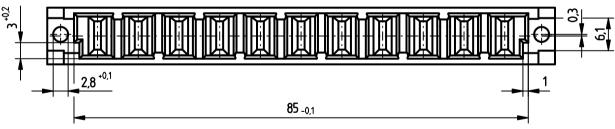
Flachstecker 6,3 x 0,8 mm / Slip-on tabs 6,3 x 0,8 mm Isolierwerkstoff / hausing material : PC GF30
