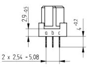
Elastische Einpresszone / compliant pressfit zone Isolierwerkstoff / hausing material : PBT GF30
