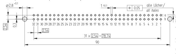
Anschluß 0,6 x 0,6 mm / terminal 0,6 x 0,6 mm Isolierwerkstoff / housing material : PBT GF30
