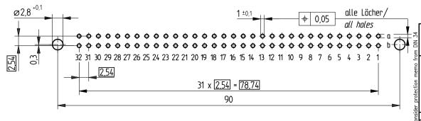
Tauchlötaschluß 0,65 x 0,3 mm / solder terminal 0,65 x 0,3 mm Isolierwerkstoff / housing material : PBT GF30
