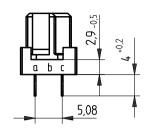
Tauchlötaschluß 0,65 x 0,3 mm / solder terminal 0,65 x 0,3 mm Isolierwerkstoff / housing material : PBT GF30
