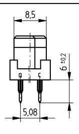
Elastische Einpresszone 2,5 mm / compliant pressfit zone 2,5 mm Isolierwerkstoff / housing material : LCP GF30
