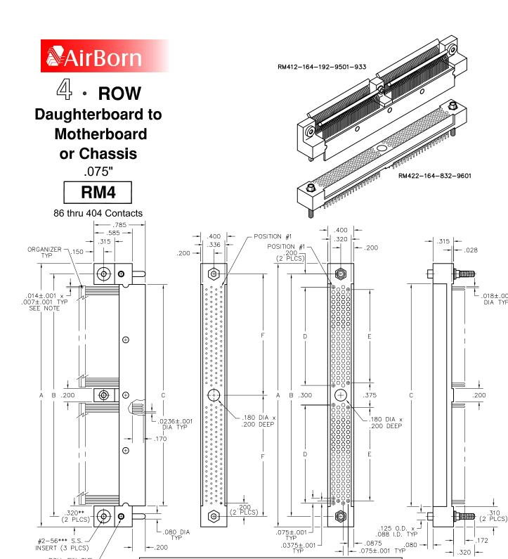
DIMENSIONS В Ε F RCPT RCPT PLUG PLUG 2.255 2.295 1.975 1.655 1.675 1.575 1.500 \_ 2.425 1.950 110\* 2.745 2.745 2.105 2.125 2.025 164 3.700 3.380 1.500 4.020 4.020 3.400 1.425 1.850 4.300 1.800 1.725 196 4.620 4.620 3.980 4.000 2.150 204 4.770 1.875 1.800 2.225 4.770 4.450 4.130 4.150 5.070 4.450 220 5.070 4.750 4.430 2.025 1.950 2.375 250\* 5.370 4.730 4.750 4.650 4.575 5.370 5.050 276 2.550 2.475 6.120 6.120 5.800 5.480 5.500 2.900 2.775 300 6.570 5.930 2.700 3.125 6.570 6.250 5.950
