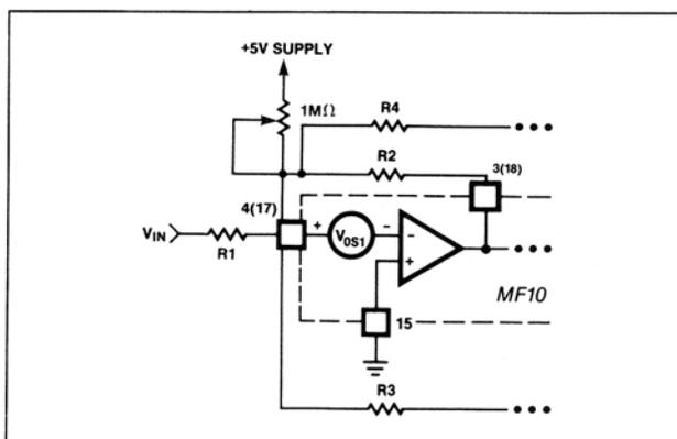
Figure 17. V<sub>OS</sub> Adjustment
