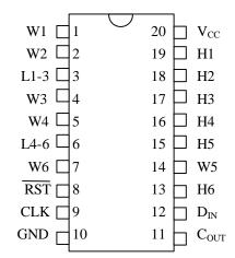
DS1806 20-Pin DIP (300-mil) DS1806S 20-Pin SOIC (300-mil) DS1806E 20-Pin TSSOP (173-mil) See Mech. Drawings Section For multiple device and single processor environments, the DS1806 can be cascaded or daisy-chained. This feature allows a single processor to control multiple devices.
