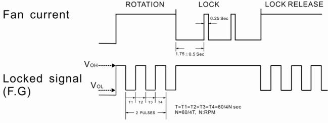
※此類IC目前有Power Noise的問題點,但不影響DC FAN及系統之運作, 建議於系統供應DC FAN之正負電源端加一47µF之電容。
