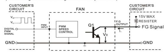
\*PWM INPUT FREQUENCY------FPWM:18KHZ~30KHZ
