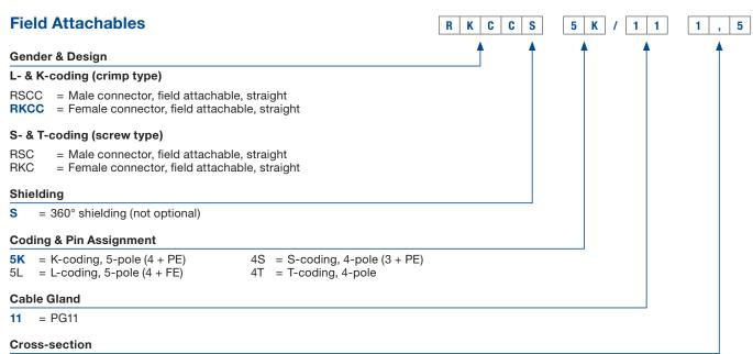
0,75 = 0.75 mm<sup>2</sup> crimp-contact (L- & K-coding)
