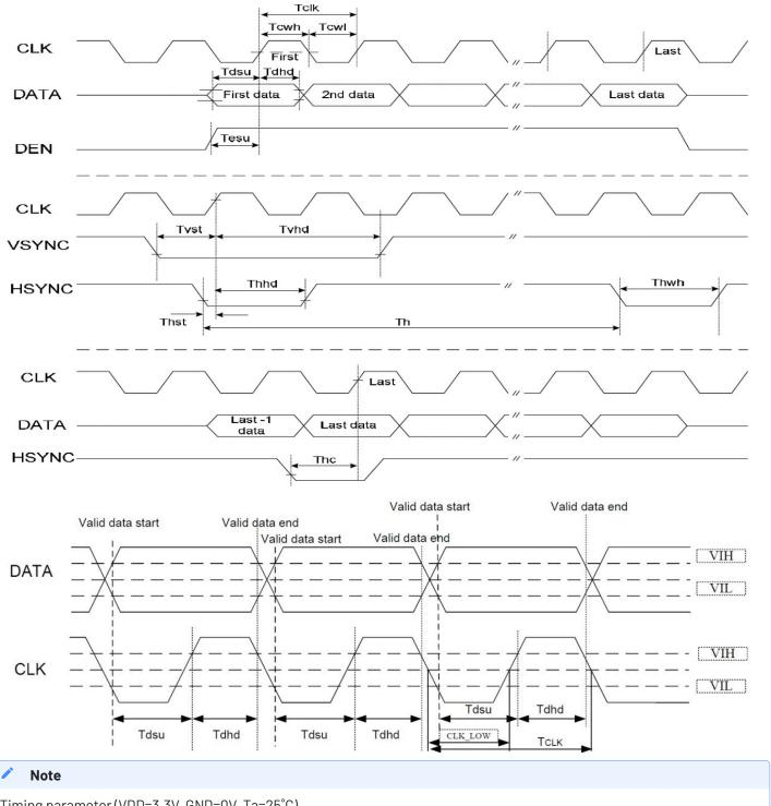
Timing parameter (VDD=3.3V, GND=0V, Ta=25°C)
